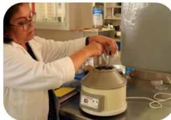
Centrifugación de suelo en solución de acetona y hexano.
