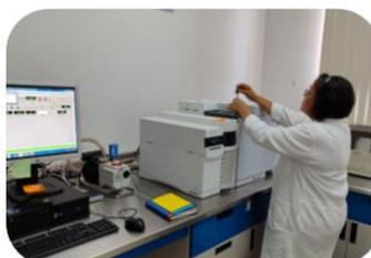
Inserción de la fibra SPME en el inyector del cromatógrafo para liberación de compuestos y su análisis.
