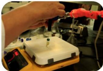
Agitación de resuspensión de sobrenadante de muestra de suelo y extracción de compuestos con una fibra SPME.
